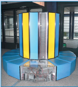
Компьютеры Cray весили от 1 до 6 тонн и использовались охлаждение фреоном. Это вам не «водянка» с диодной подсветкой.
